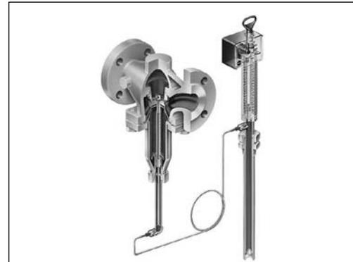
Válvula Tipo 4 con termostato de regulación Tipo 2231 (dibujo sección)
